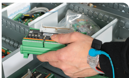
Σύστημα προστασίας ESD
